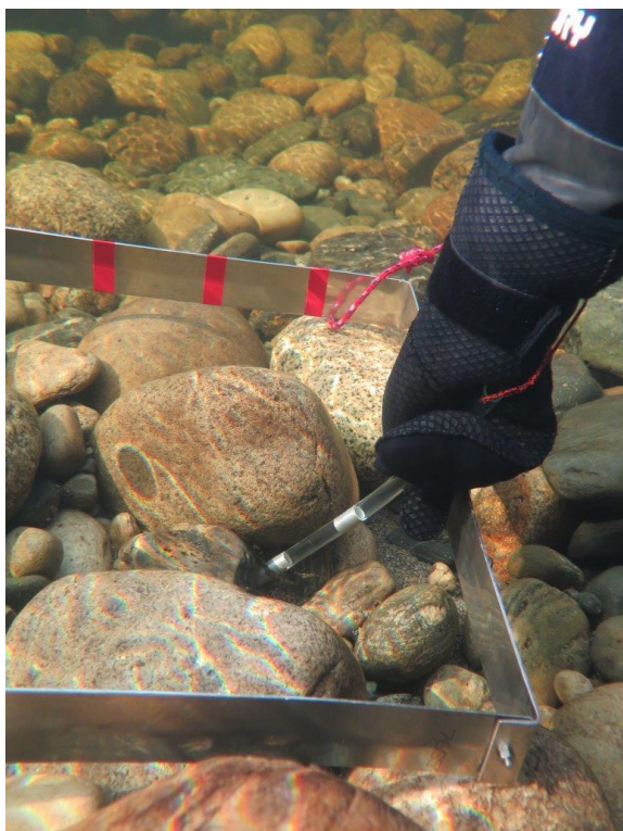
Figur 52. Skjul vurderes innenfor en ramme på 0,25 m 2 . Størrelsen på hulrommene blir bestemt ut fra hvor langt ned mellom steinene plastslangen kan stikkes, og deles opp i tre skjulkategorier; S1: 2-5 cm, S2: 5-10 cm, og S3: > 10 cm. (Foto: Håkon Gregersen).
